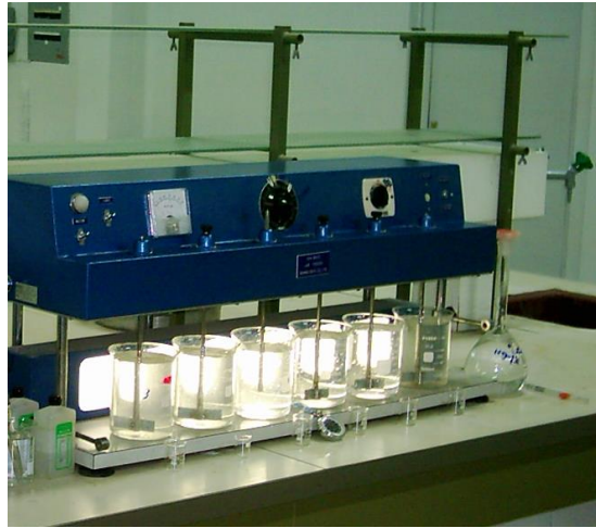
شكل رقم (6) جهاز فحص الجرة (Jar test)
