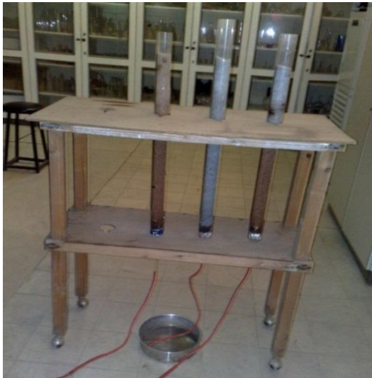
شكل رقم (1) خصائص عمود الترشيح المختبري
